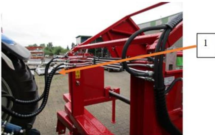
Les deux tuyaux hydrauliques (1) sont raccordés à un distributeur à double effet.
