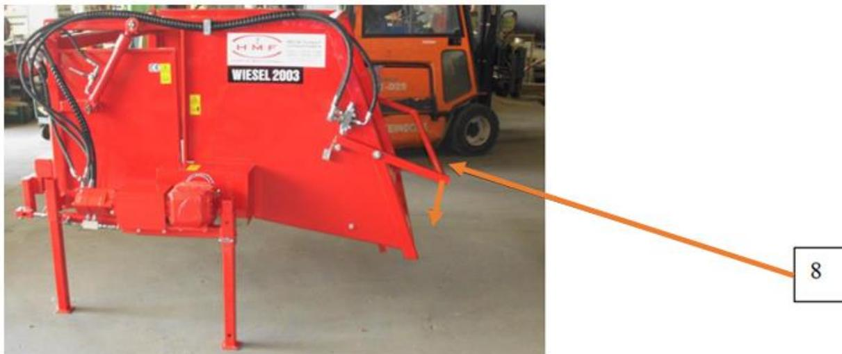
L'arceau arrière (8) est un arceau d'arrêt d'urgence et d'espacement. Si l'arceau est abaissé vers le bas, l'enrouleuse s'arrête automatiquement.
