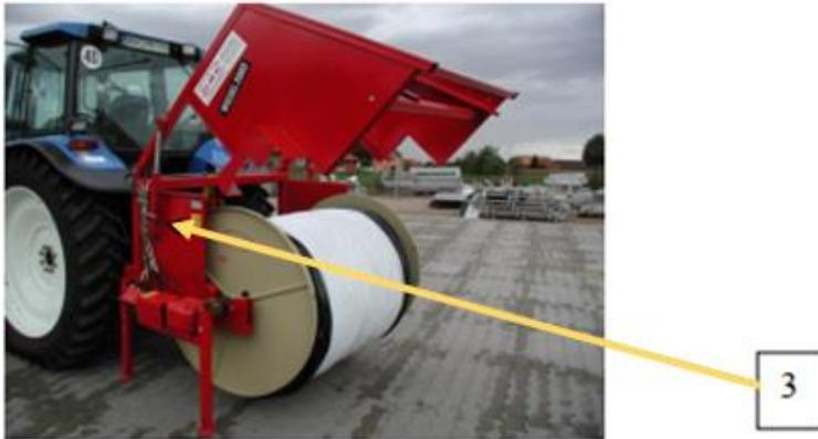
Le sens de fonctionnement du moteur pour l'enroulement et le déroulement du film est réglé dans un sens (dans le sens inverse des aiguilles d'une montre).
