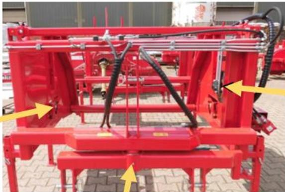
**Sämtliche Lager mit Schmiernippel sind in regelmäßigen Abständen (alle 20 Betriebsstunden) mit Mehrzweck-Fett abzuschmieren.**
