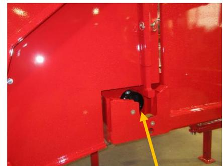
Kupplung für das Haspelrohr
