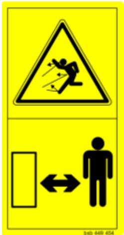
**Vorsicht! Gefahr durch herausschleudernde Teile bei laufender Maschine.**
