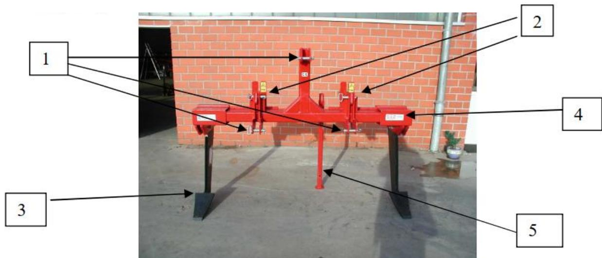
Der Tiefenspaten MAULWURF wird an den Dreipunkthebel des Traktors angeschlossen (1).
