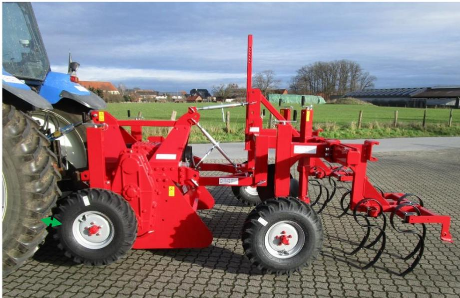
Lors du montage du cultivateur rotatif à l'arrière, il convient de noter que les roues du cultivateur doivent être retirées, car la distance par rapport aux roues du tracteur est trop faible.
