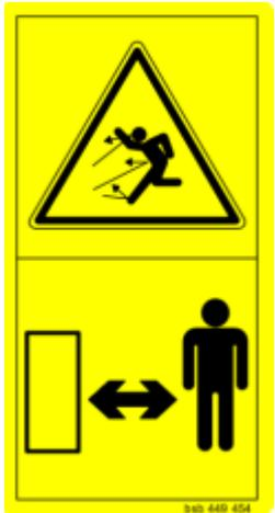
**Vorsicht! Gefahr durch herausschleudernde Teile bei laufender Maschine.**
