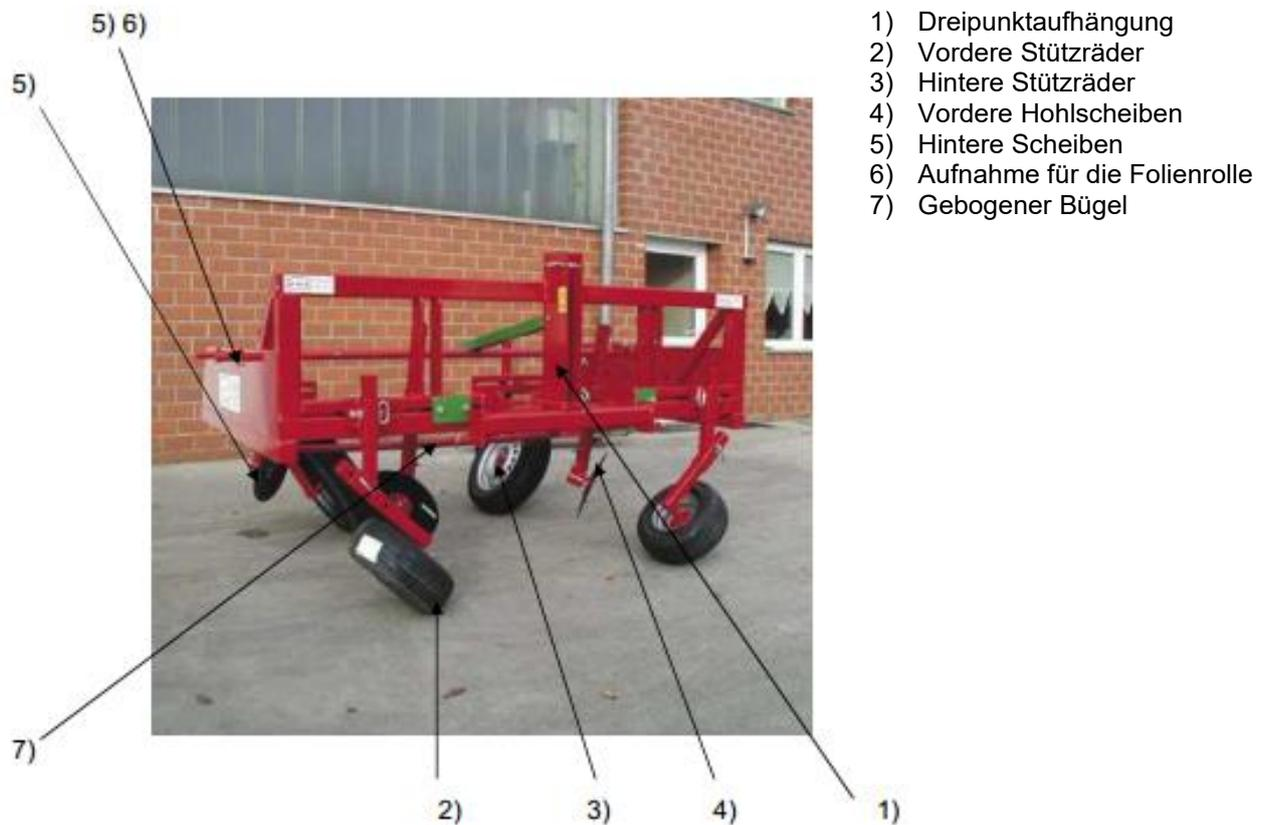
Die Dreipunktaufhängung (1) ist pendelnd an der Maschine angebracht. Mittels zweier Stellschrauben kann die Beweglichkeit des Dreipunktbockes eingestellt werden. Die Maschine rollt auf zwei vorderen schräggestellten Stützrädern (2) und zwei hinteren großen Rädern (3), die gleichzeitig auch die Folie an den Damm drücken. Durch das Schrägstellen der Räder ist eine Führung entlang des Dammes gewährleistet.
