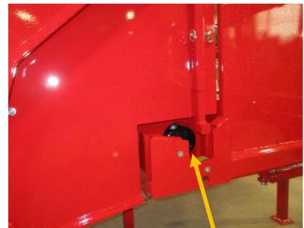
Kupplung für das Haspelrohr
